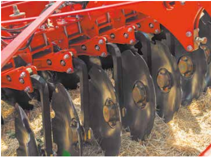
Стійки з високоміцної сталі
