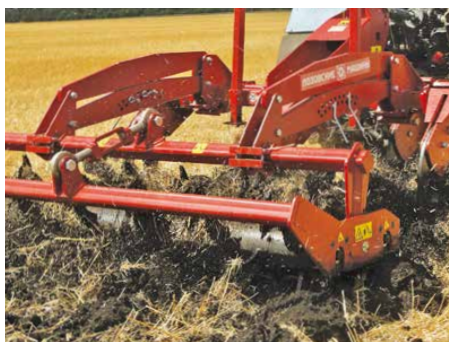
Балансирна установка котків
