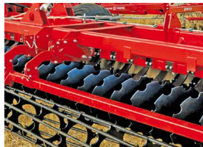
Прутьово-кільцевий коток без центральної осі, що не забивається
