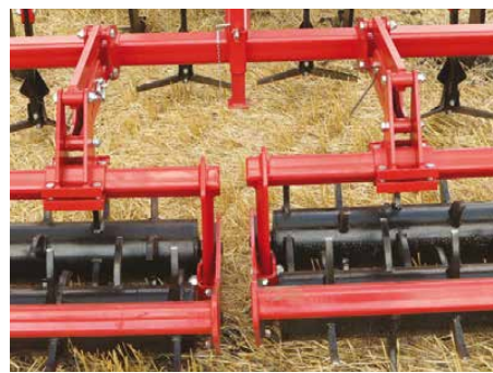
Переваги шпорового самоочисного котка
