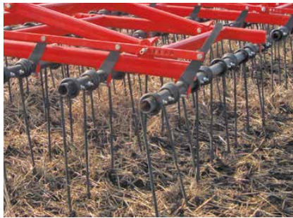
Можливість регулювання кутів атаки
