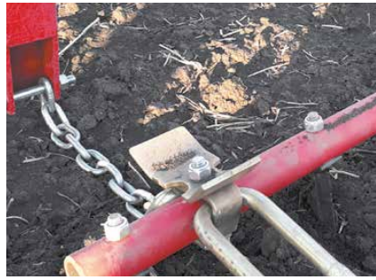
Регулювання кута атаки зуба
