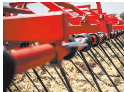
Zęby odporne na zużycie
