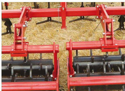
Zalety samooczyszczającego się wału Kolczastego
