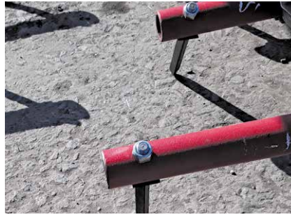
Ząb o wysokiej wytrzymałości w kształcie rombu
