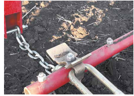
Regulacja kąta natarcia zęba
