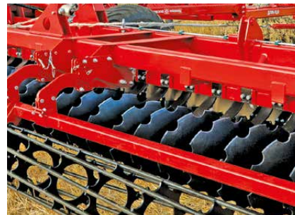
Незабивающийся прутково-клетевой каток без центральной оси
