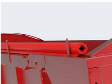
Все прицепы (кроме тех, что комплектуются шнеком-перегрузателем и дополнительными бортами) могут комплектоваться тентом с ручным приводом. В свернутом состоянии тент уложен на левом борту прицепа.
