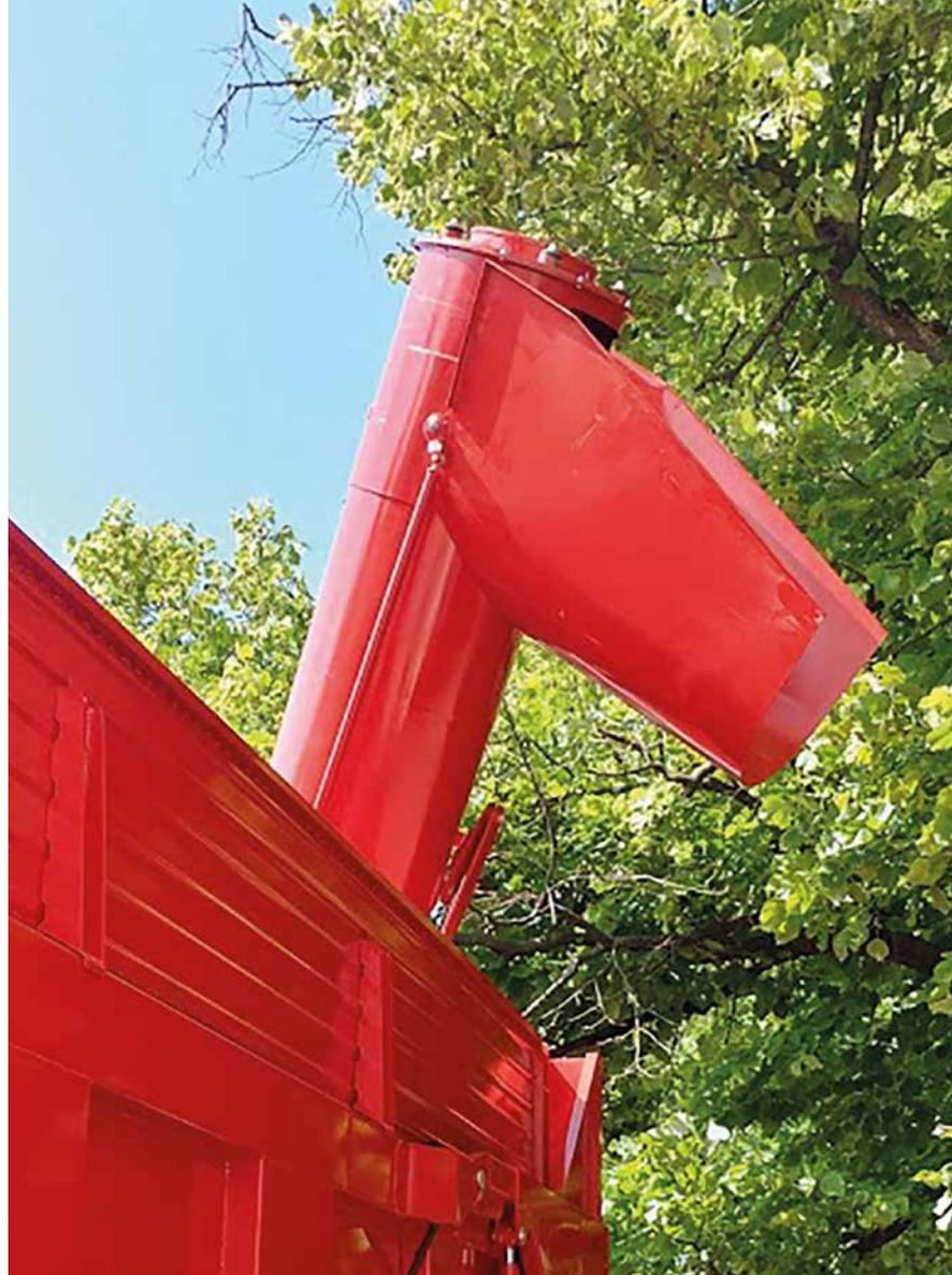
Прицеп ALBION XL (двухосный самосвальный полуприцеп на модернизированном шасси) с базовым объемом 26 м<sup>3</sup> (а с дополнительными бортами 37 м<sup>3</sup>) отличается высокой грузоподъемностью – 20 т. Это позволяет перевозить разные типы грузов - не только зерновые, но и другие виды грузов: корнеплоды, силосную массу, щебень.
