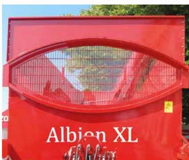
Переднее смотровое окно большого размера для удобного визуального контроля заполнения прицепа с кабины трактора.
