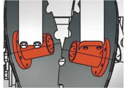
Solution du problème de sillon du disque extrême
