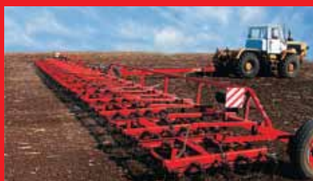
LIRA Širokorozchodné brány s hroty na pružinách s hydraulickým pohonem
